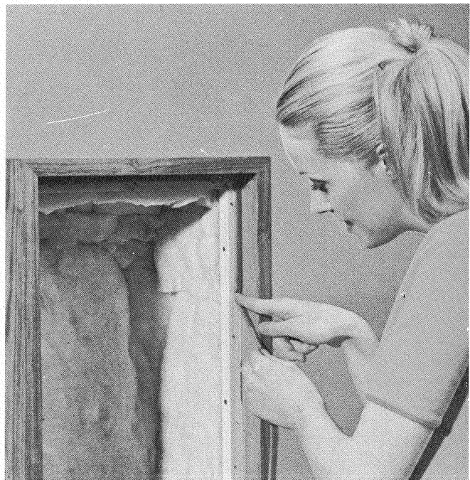
Fig. 10 - Lungo la superficie frontale dei listelli anteriori va incollato il solito nastro adesivo in gomma-piuma
