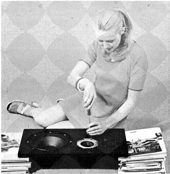
Fig. 3 - Il pannello frontale va verniciato di nero. Gli altoparlanti devono essere fissati in maniera che i loro terminali di collegamento si trovino davanti a quelli del filtro in modo da evitare lunghi percorsi
