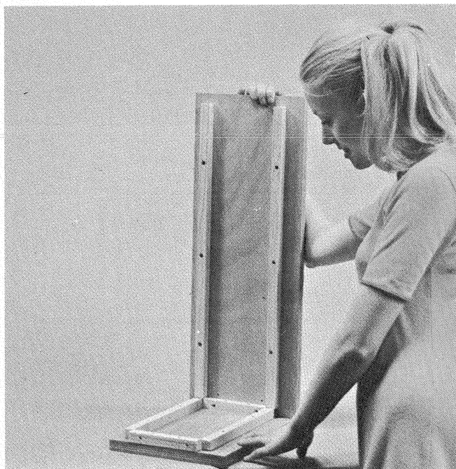
Fig. 7 - Indica come debbono essere fissati i pannelli laterali al piano di base
