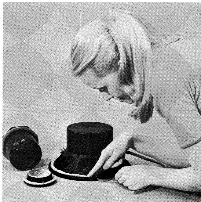
Fig. 2 - Sulla flangia posteriore degli altoparlanti va applicato prima del fissaggio un nastro adesivo di gomma-piuma.
